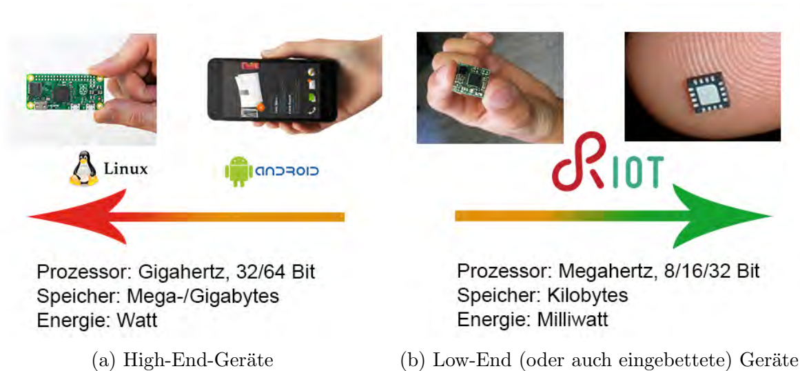
Abbildung 5.10: Vergleich von Hardware-Ressourcen bei High- und Low-End-Geräten im IoT und exemplarische Betriebssysteme.
