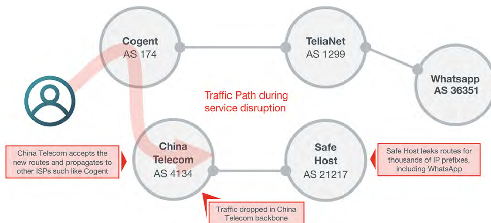
Abbildung 2.45: Topologie des Route Leaks 15
