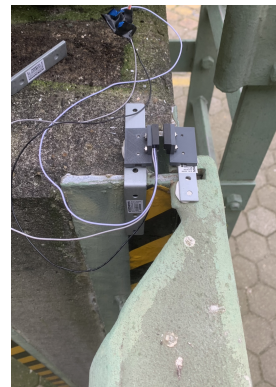
Abbildung 4.2: Temporäre Befestigung eines Reed Sensors
